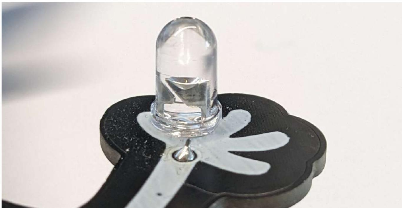
Löte die Diode an und knipse die überstehenden Beinchen ab.
